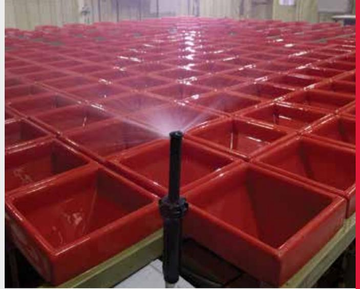
Test in laboratorio e sul campo da parte di terze parti dimostrano un'efficienza pari al 15–20% in più rispetto agli ugelli della concorrenza a 4,6 m o meno.
